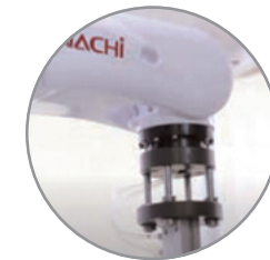
로봇을 이용한 제조프로세스 단순화 및 오염 최소화 ※용기캡분리, 원료공급, Sub 원료 연결 등
